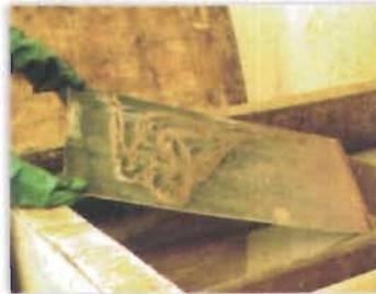
6. Se agita la bandeja para que el ácido muerda de manera uniforme la placa.
