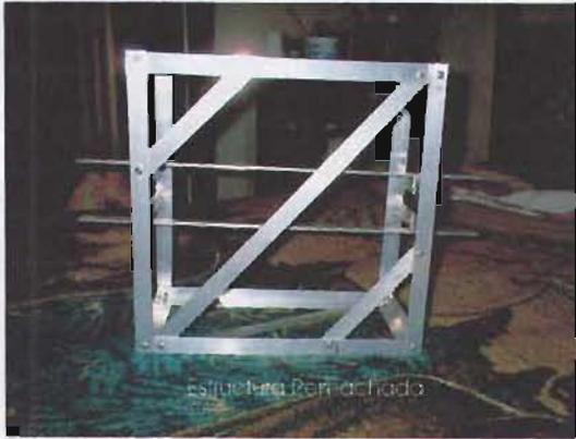
**11.** A partir del modelo a escala se armó una estructura de aluminio capaz de resistir el peso de todos los materiales y aplicaciones plásticas.
