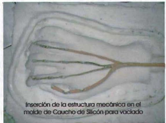
**21.** Se realizó el vaciado de la mano, pero los componentes reaccionaron de forma diferente: debido al metal la mano se tornó rígida, lo que resultó en pérdida de material y desgaste al volver a comenzar la mano debido a que se fracturó la estructura metálica y los chicotes se rompieron.
