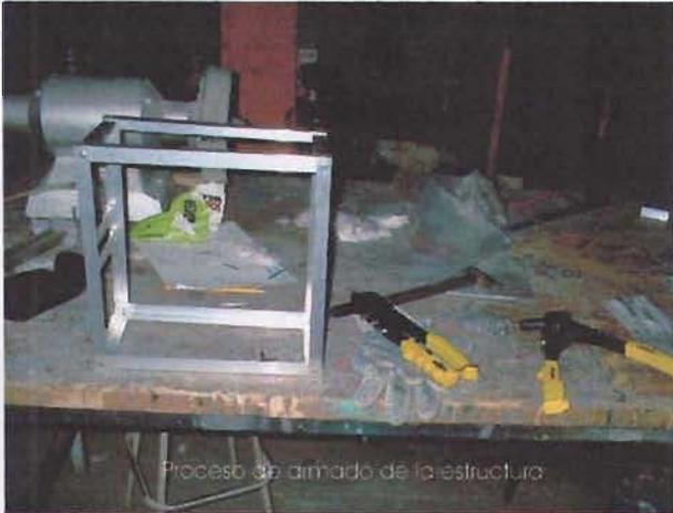
Al contar con los materiales comenzamos el proyecto del libro objeto al unir por medio de remaches de tamaño estándar las piezas de aluminio gracias a orificios que se taladraron para ensamblar el ángulo de aluminio por medio de remaches y demás piezas que a partir del modelo a escala se fueron perfeccionando y modificando junto a la idea
