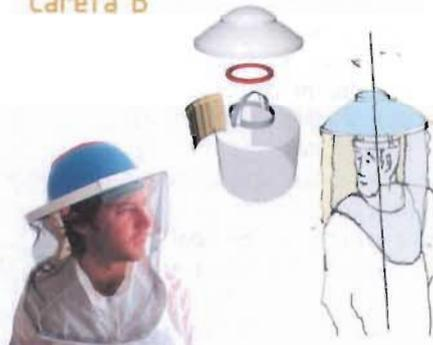
En esta propuesta se utiliza un sombrero inyectado en polipropileno para mantener la estructura del velo rígida, además su estructura es aprovechada para alojar el sistema de giro de la diadema de soldador que le proporciona al usuario seguridad y confort evitando que el velo se arrugue. La desventaja es el peso y la complejidad del sistema de giro elevando costos de producción haciendolo poco viable. En prueba con modelos el velo sigue mostrando pliegues.
