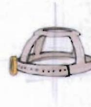
Mecanismo que se utiliza para ajustar la careta al diametro de la cabeza del usuario.
