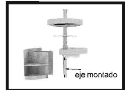
12-Colocar el eje con todos sus elementos en la base inferior ubicada entre los paneles.
