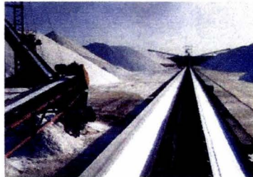
23.- Bandas transportadoras conducen la sal hacia y desde los apilamientos, (ESSA).
