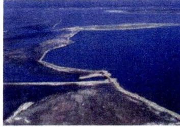
5.- Diques separando uno de otro los vasos concentradores y el mar, (ESSA).
