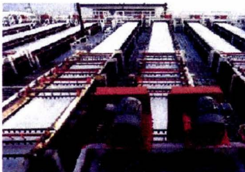
16.- Sección de lavado por aspersión, (ESSA).
