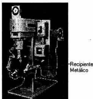
Figura 3.1: Fotografía del molino de Atrición de alta velocidad de modo continuo con aplicaciones de molienda fina, tomada del sitio web: www.unionprocess.com/pdf/labattritors.pdf .
