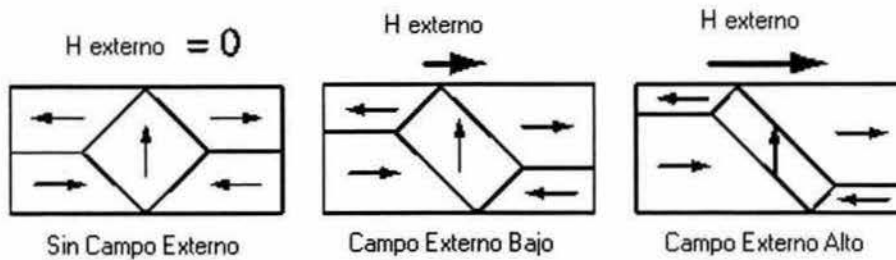
Figura 2.11: Dominios que cambian su dirección de magnetización aproximándose a la dirección del campo aplicado H .
