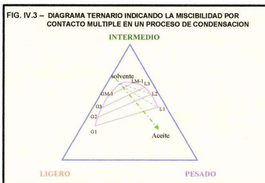
En la figura anterior se puede observar una “zona de transición” entre las composiciones del aceite del yacimiento (L1, L2, L3... Ln) sobre la curva de puntos de burbuja hacia la composición del gas inyectado”. El solvente tiene un primer contacto miscible con el líquido en equilibrio LM-1, el cual hace su primer contacto miscible con el líquido en equilibrio LM-2, y así sucesivamente. Este proceso domina el lado principal de la zona de transición.
