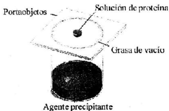
Figura 11. Método de difusión de vapor en gota colgante para cristalizar proteínas.
