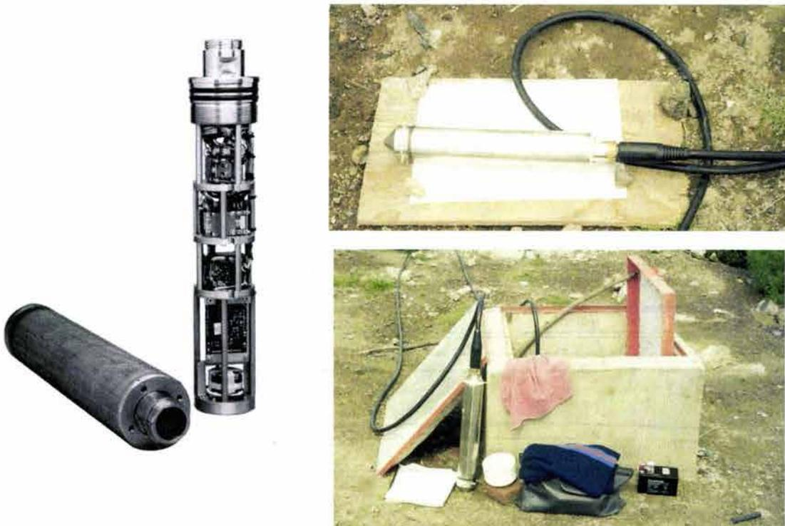
Fig. 4.11 Sonda para la medición de aceleraciones en un pozo, a 60 m de profundidad
