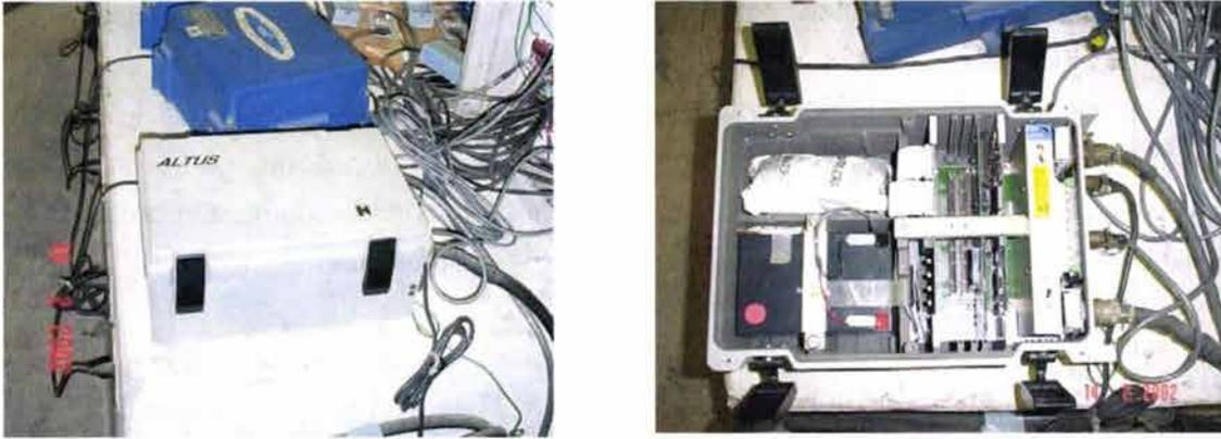
Fig. 4.12 Registrador de aceleraciones K2 para los conjuntos triaxiales de superficie y pozo
