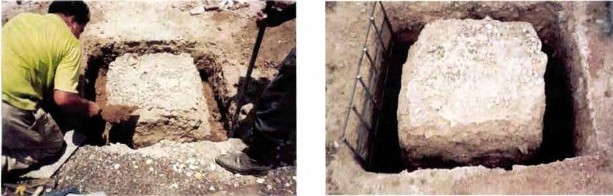
*Fig. 4.9 Proceso para la colocación de la base para los acelerómetros de superficie en campo libre, sobre un núcleo de suelo intacto*
