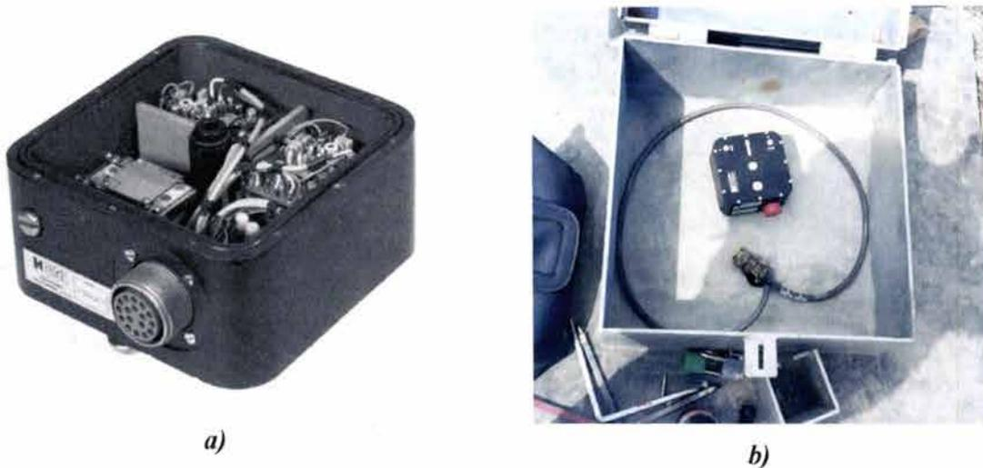
*Fig. 4.10 a) Acercamiento de acelerómetros colocados en la la superficie del terreno, b) acelerómetros de superficie alojados dentro de la caja hermética*
