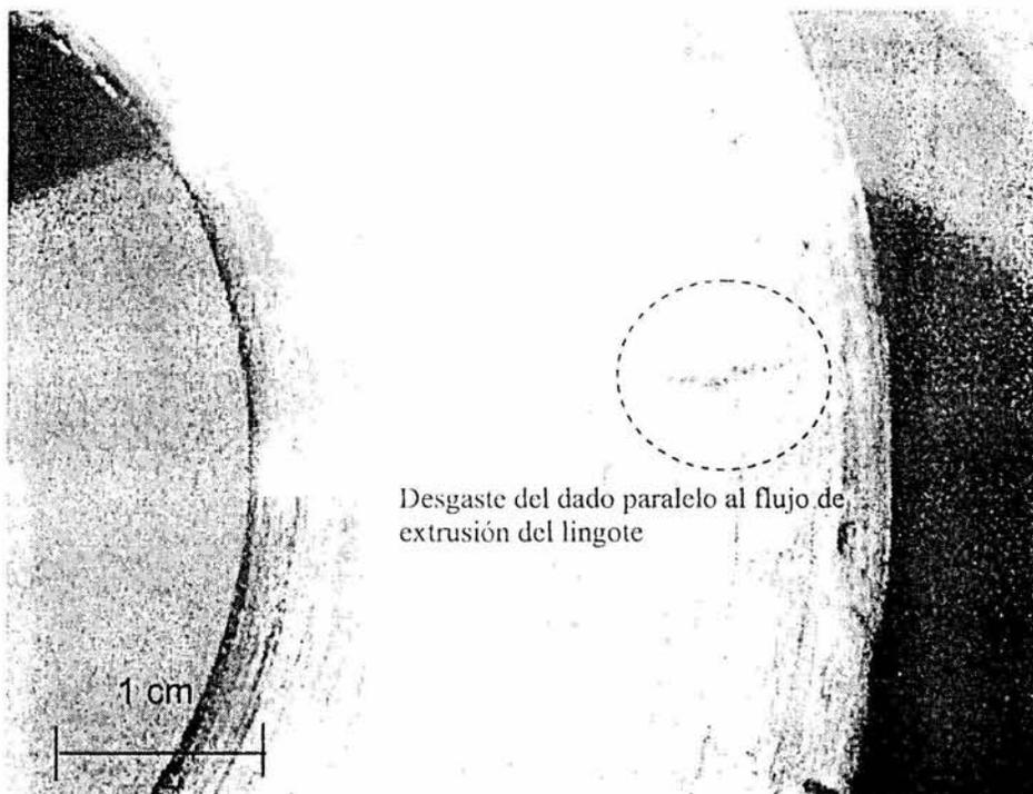
Figura 22. Detalle del desprendimiento del dado de acero, luego de haberse usado para extruir un lingote de cobre durante 45 segundos a 920 °C.
