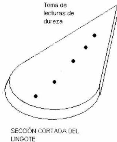
*Figura 6. Forma en la que se realizó la toma de lecturas de la dureza a cada parte del disco o muestra del lingote mencionado en la figura 1.*
