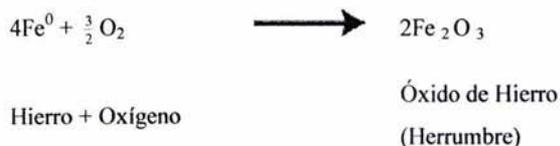
La formación de las películas de óxido por oxidación atmosférica puede ser considerada lenta y puede acelerarse utilizando agentes tales como el  $\text{CrO}_3$  en solución acuosa<sup>11</sup>.
