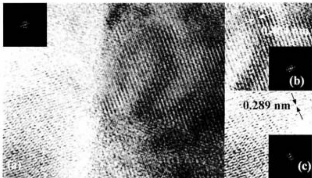
Figura 3-42: Imagen de microscopía de alta resolución en la que se aprecia la superposición de varios cristálitos.
