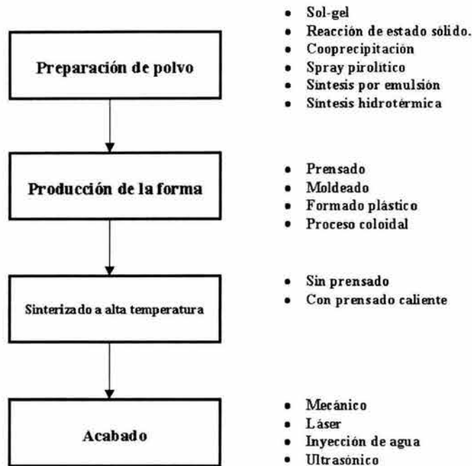
Figura 1-3: Cuatro pasos involucrados en la preparación de cerámicas avanzadas.
