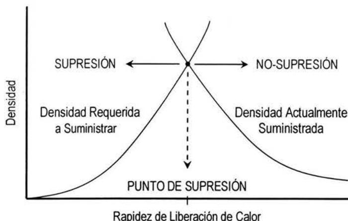
**Figura 2** Gráfica típica en donde se muestra el punto de supresión de un incendio en relación con la cantidad de agente extintor aplicado y la severidad del fuego [5].
