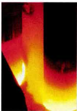
Chorro de Colada continua
