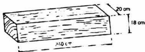
Dimensiones del durmiente de madera
