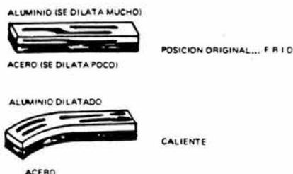
Figura III.5.- Principio Físico de Dispositivos Bimetálicos.
