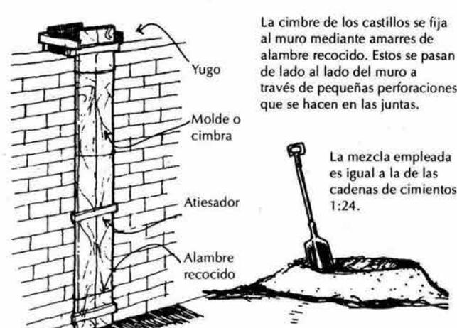
La cimbre de los castillos se fija al muro mediante amarres de alambre recocado. Estos se pasan de lado al lado del muro a través de pequeñas perforaciones que se hacen en las juntas.
