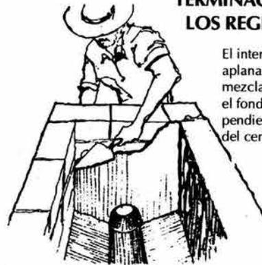
El interior del registro debe aplanarse y pulirse con una mezcla de cemento y arena el fondo debe tener pendiente hacia el canal del centro.
