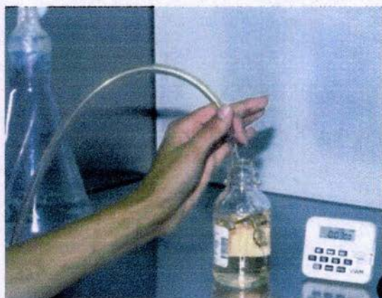
Figura 14. Gaseado de la botella de 100 cc de medio F-10 de Ham con la mezcla gaseada de 90% N 2 , 5% O 2 , y 5% CO 2 durante 3 a 5 minutos.
