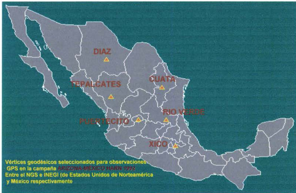
Figura 2.1. Esquema de distribución de las estaciones del Proyecto Arizona-México HARN 1992
