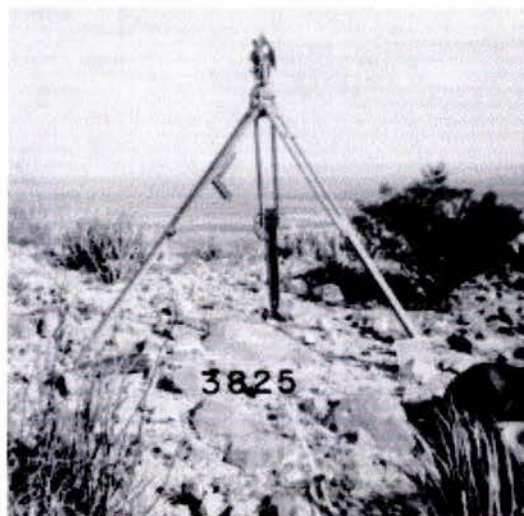
Figura 1.3. La medida de los ángulos entre vértices requería intervisibilidad de éstos últimos
