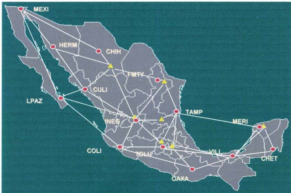
Figura 3.3. Liga de las estaciones de la RGNA a las estaciones de alta precisión con coordenadas ITRF
