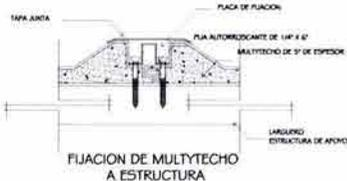
**NOTAS IMPORTANTES:** LA LAMINA DE MULTIPANEL ANTES DE SER LA POSICIONADA DEBE MEDIRSE Y VERIFICAR LA ESTRUCTURA DE SOPORTE, LA CUAL DEBERA ESTAR PERFECTAMENTE ALICATADA, ALINEADA Y PERFORADA EN EL PUNTO DE MONTAJE QUE SE ENCONTRE EN LOS PUNTO DE SOSTEN. LOS PUNTO DE SOSTEN DEBE SER UN PUNTO DE MONTAJE DE MULTIPANEL DE 30\"/>
