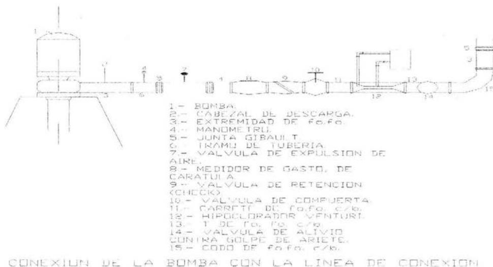
Figura 9.- Ejemplo representativo del arreglo que se hace en relación a la bomba con la línea de conducción.
