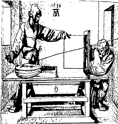
figura 13. Ilustración de tipo técnico realizada por Alberto Durero. Uso de un marco para dibujar un laúd en perspectiva.
