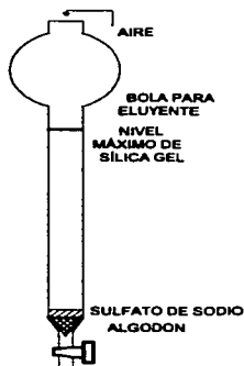
Figura 1.4. ESQUEMA DE COLUMNA PARA PURIFICACIÓN.
