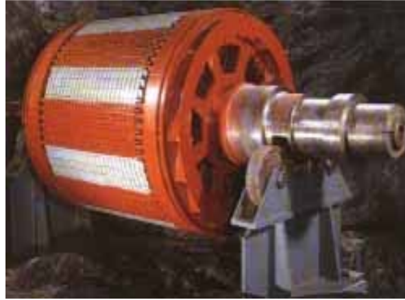
FIGURA 1.4 VISTA DE UN MOTOR SINCRONO.
