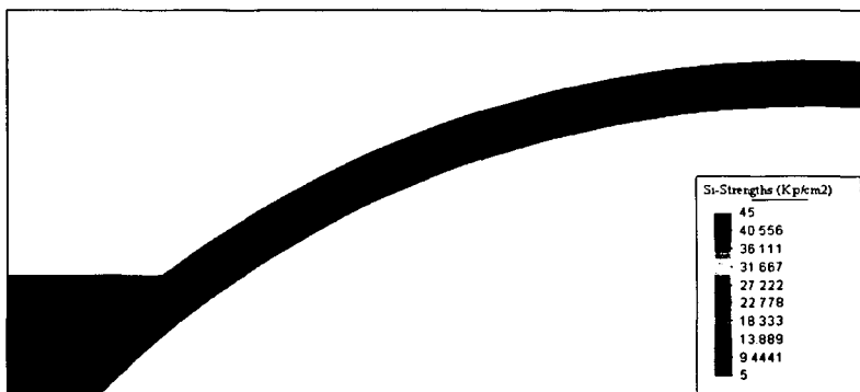
Fig. 118 Esfuerzos permisibles (en color negro).
