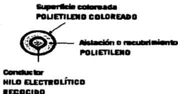
Figura 2.1. Estructura de un hilo conductor para par trenzado.
