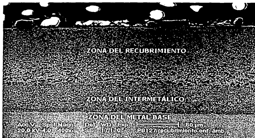
FIGURA 6.1 VISTA GENERAL DE LA PROBETA SOLO INMERSIÓN EN METAL FUNDIDO
