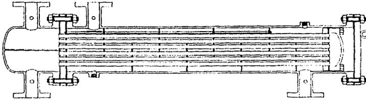
Figura 2.5.- Intercambiador de calor de Cabezal Flotante
