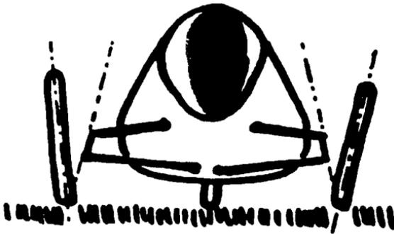
c) Camber cero. Es cuando las ruedas se encuentran perpendiculares con respecto al piso. Esta conformación dificulta el manejo del auto y envía mucha carga a los pivotes (pernos maestros) de la dirección.
