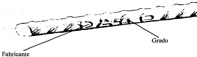
Figura II.8 Varilla grado 60. (Cortesía DEACERO.)
