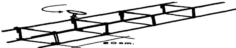
Figura IV.22 Amarres de varillas con alambre recocado.
