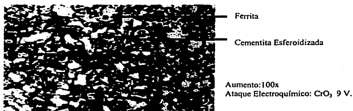
Fig.3.24 Fotografía de la unión soldada ASTM T-22 / AWS ER-502. Se observa la cementita esferoidizada.
