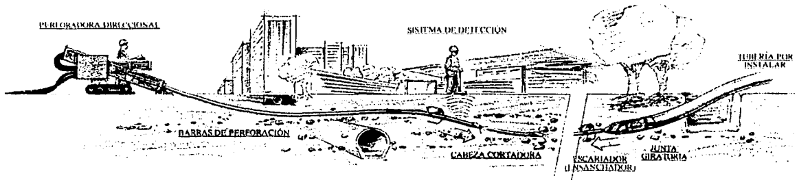
Fig. 3.21 Esquema del método de Perforación Direccional.
