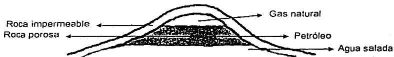
Diagrama de un yacimiento de petróleo y gas natural. En una estructura con forma de Domo La roca porosa (arenisca) contiene impregnados en su interior gas, petróleo, y agua salada
