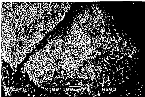
Fig. 3.26 Tamaño y estructura característicos de las partículas obtenidas después de 6 horas de reacción.
