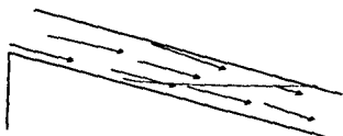
fig. 5. Plano inclinado en el cual escurre un fluido por acción de la gravedad
