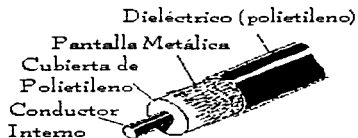
Figura 1.2. Estructura Típica De Un Cable Coaxial.
