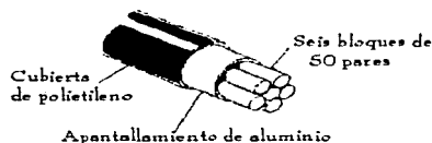
Figura 1.1. Estructura Típica De Un Cable De Pares.
