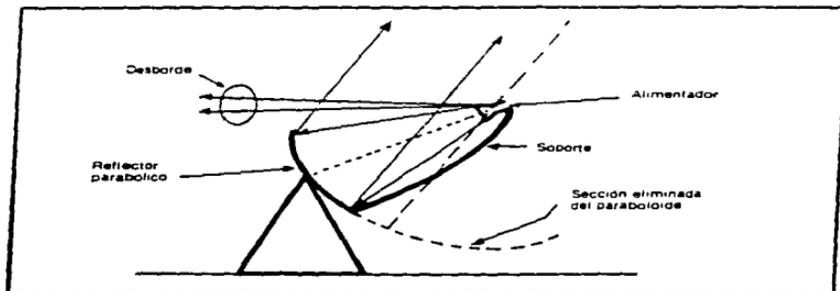
Figura 1.21. Antena de *offset* (modo de transmisión)
