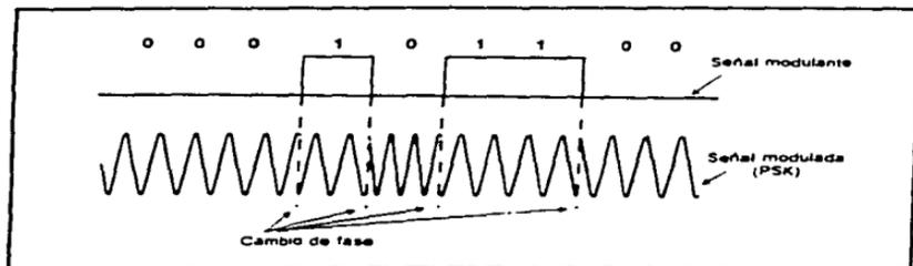
Figura 1.7 Señal modulada en fase por una señal modulante digital
