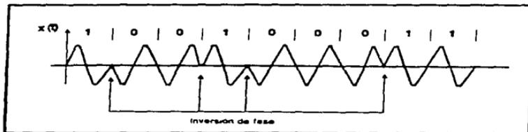
Figura 1.8. Señal BPSK en función del tiempo.
