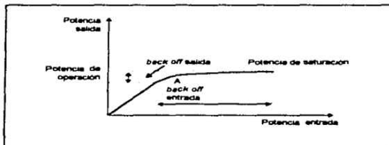
Figura 2.14. Operación de un amplificador de satélite.
