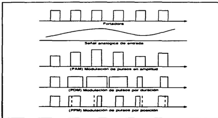
Figura 1.11. Sistemas de modulación por pulsos.
