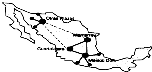
Figura 4.11 Topología de la red Frame Relay
