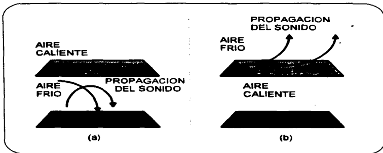
Figura 1.9.4 Efectos de gradientes de temperatura en la propagación del sonido.
