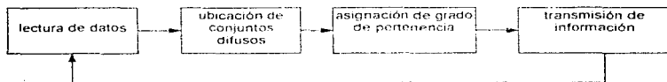
fig. 5-7 Diagrama a bloques del programa del módulo de adquisición de datos y fusificación
