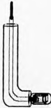
Fig. 5.10. Electrodo de Trabajo dentro del Tubo de Vidrio.
