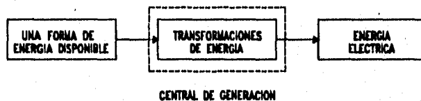
Figura 1.1 Transformación de energía en una central de generación.
