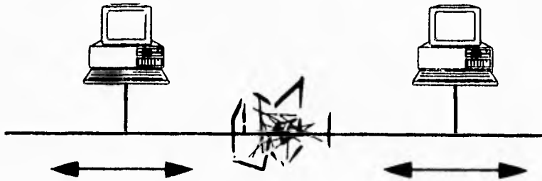
Figura 17. Cuando múltiples estaciones transmiten simultáneamente, los paquetes colisionan sobre el cable
