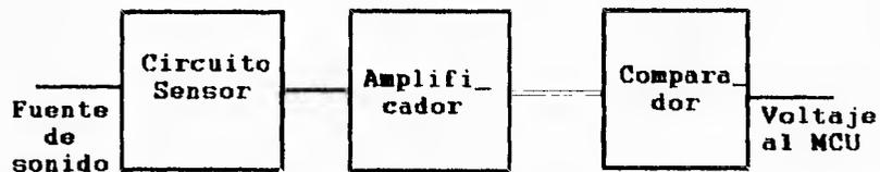
Figura IV.1.4.1 Diagrama de bloques del sensor de audio.
