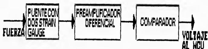
Figura IV.1.2.1 Diagrama de bloques del sistema de acoplamiento del sensor de fuerza.
