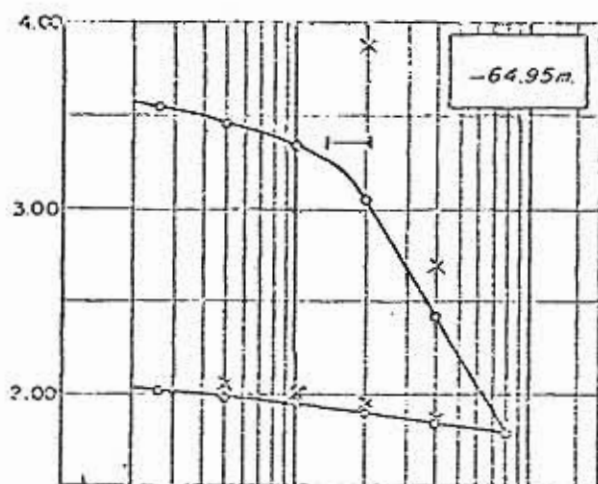
Fig. 5e. Curvas de consolidación (sondeo BNP-3). Comparación entre puntos teóricos y experimentales.
