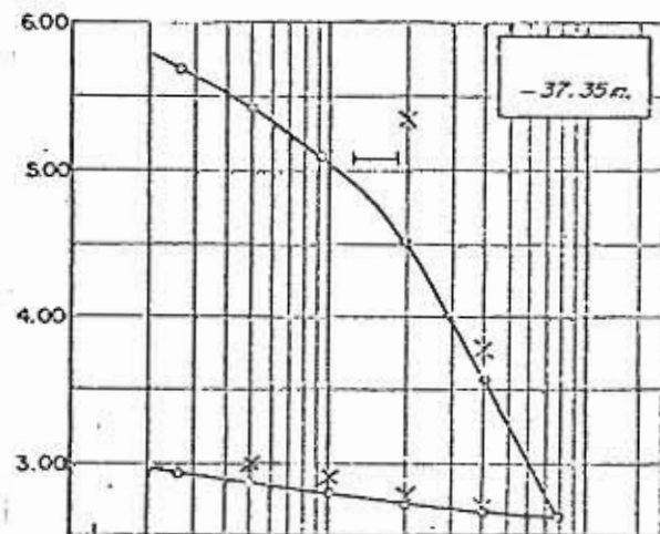
Fig. 5d. Curvas de consolidación (sondeo BNP-3). Comparación entre puntos teóricos y experimentales.
