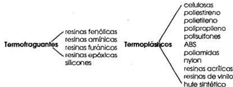
"Los primeras son formadas bajo calor con o sin presión, resultando un producto que es permanentemente duro. Los procesos utilizados para este tipo de plásticos son la compresión o moldeo por transferencia, colado, laminado e impregnado. Los compues-
