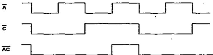
Una vez obtenido el diagrama de tiempo de las señales que entregan las compuertas AND, obtendremos las señales que nos proporciona el Circuito Troceador de Pulsos a través de las compuertas NOR de salida. Para la primera compuerta NOR tenemos:
