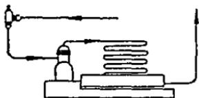
Fig. 250.—Instalación de la válvula reguladora de arranque en la línea de aspiración, lo más cerca posible del compresor.
