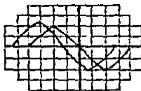
FIG. 4.5 MEDIDA DE DESPLAZAMIENTO DE FASE USANDO LA ESCALA HORIZONTAL.
