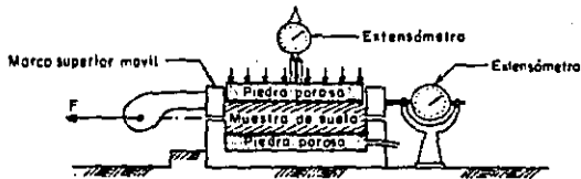
FIG. 17 PRUEBA DE CORTE DIRECTO
