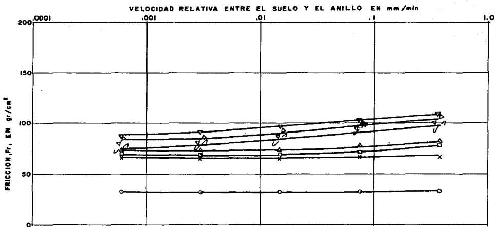
FIG. A-5 VARIACION DE LA FRICCIÓN ENTRE EL SUELO Y EL ANILLO DEL ENSAYE, "B", CON GRASA DE SILICON
